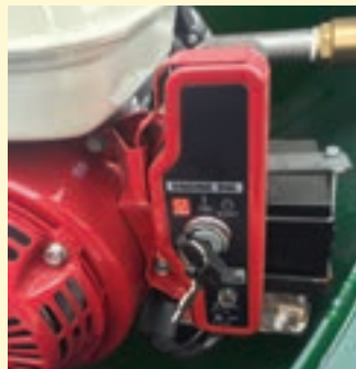
Honda 4-Takt-Motor mit elektrischem Anlasser
